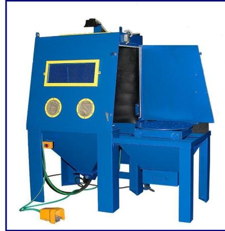
+ Выдвижной поворотный стол  $\varnothing$  600 мм (нагрузка до 500кг) с приставным бункером и направляющими для выдвижной тележки
